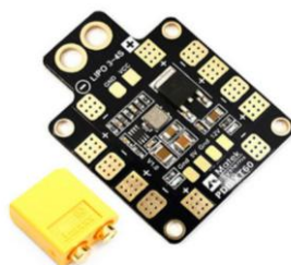
4.2 - сурет – PDB-XT60 электр сымдарын бөлу тақтасы
